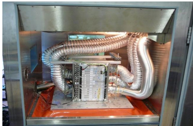
Enceinte climatique Typhoon 2.5 de Qualmark pour des tests de type HALT (incl. vibrations aléatoires)
