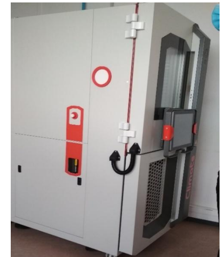
Chambre HAST Climats EXCAL² -1421-HA avec un complément d'installation pour l'humidité.
