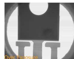
Vues du transistor en tomographie à rayons X
