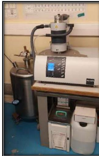
Analyseur thermomécanique NETZSCH TMA 402 F1 Hyperion
