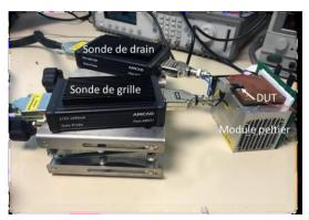
Caractérisation électrique (banc GPM)
