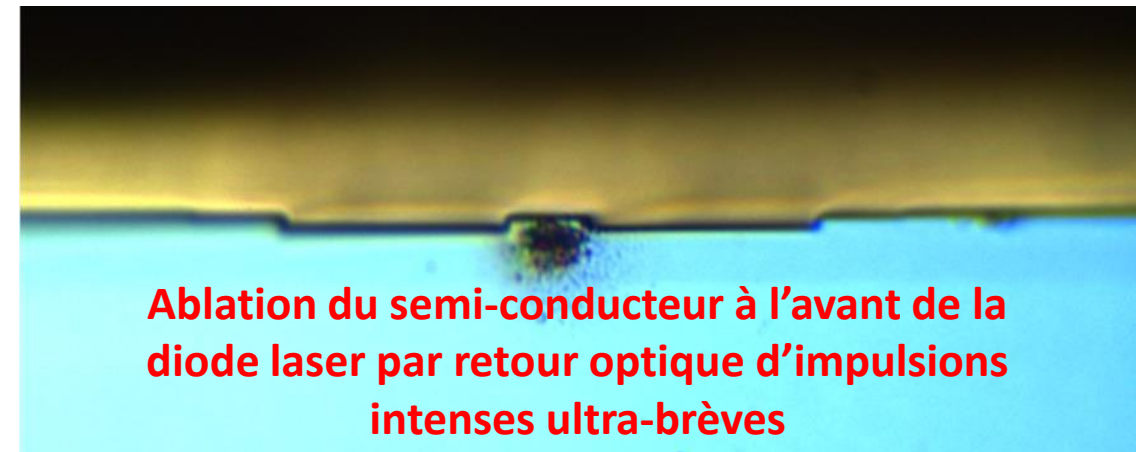
Vue de face après retrait de la fibre
