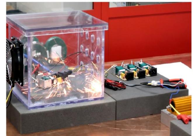
Injection d'impulsion de courant sur une alimentation
